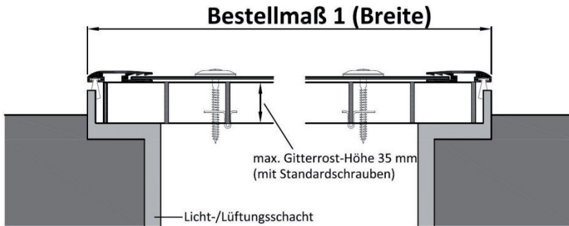
A1: LSA-Rahmen bündig mit Lichtschachtaußenmaß
